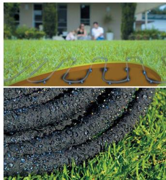
Пористый всепогодный шланг капельного полива, вода из которого просто сочится по всей длине благодаря специальной технологии изготовления самого шланга. Обеспечивает наиболее эффективное и экономичное постоянное орошение. Применяется как для наземного полива, так и для полива под землей (закапывается на 15-20 см вглубь). Вода при этом расходуется более экономно, нет испарения с верхнего слоя земли, что в свою очередь, снижает степень поражения грибок и другими болезнями.
